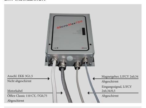
EMV-Verschraubung ist für abgeschirmtes Kabel zu verwenden. Es sind die o.g. oder gleichwertige Kabel zu verwenden, um die EMV-Richtlinie zu erfüllen.
