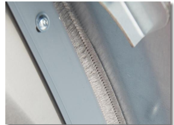
Bürstendichtung am Rotorumfang (■)
